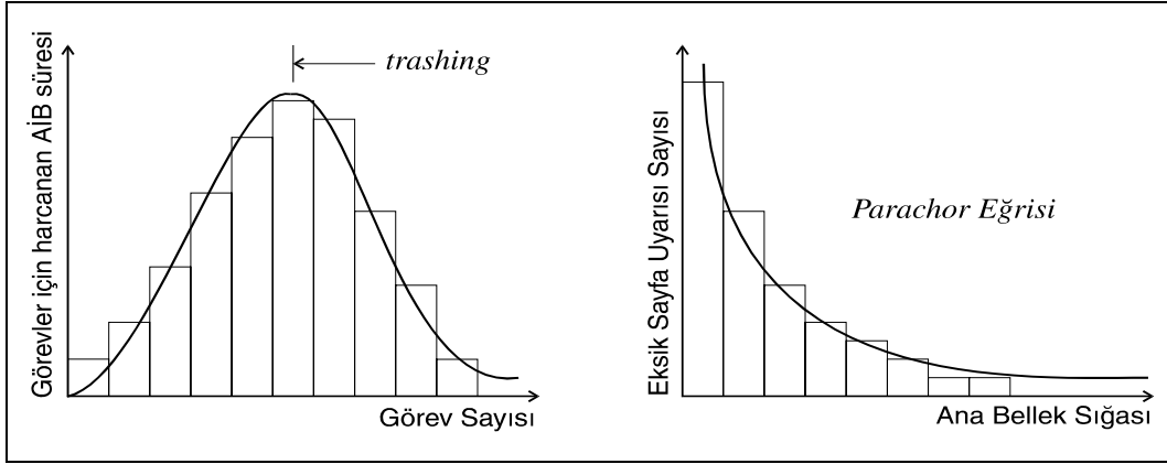
Çizim 5.27. Eksik Sayfa Uyarısı Sayısının Bellek Sığası ve Görev Sayısı ile İlişkisi
